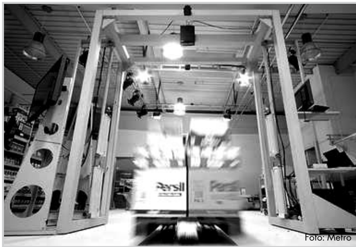
Vollautomatisierte, RFID-gesteuerte Lagerhaltung im „Extra-Future-Shop“ ...
